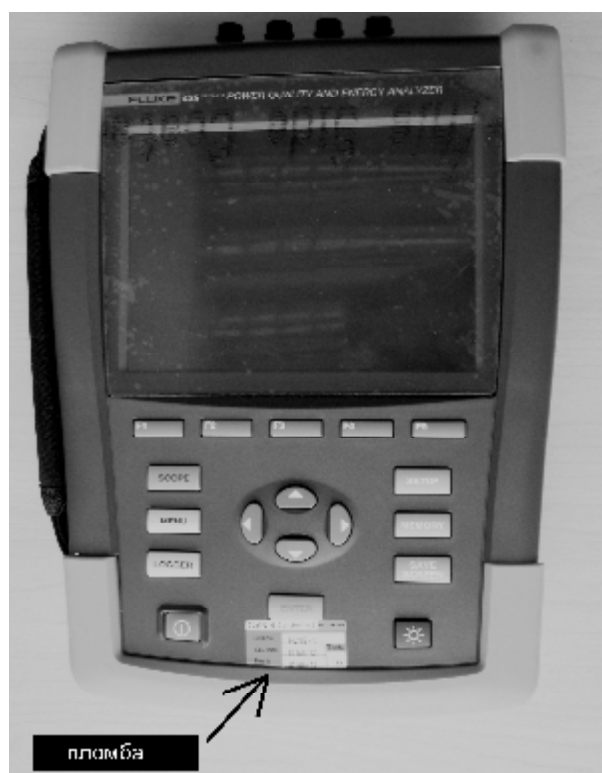
Рисунок 1. Внешний вид анализатора, стрелками показано место нанесения знака утверждения типа и место для пломбирования.
