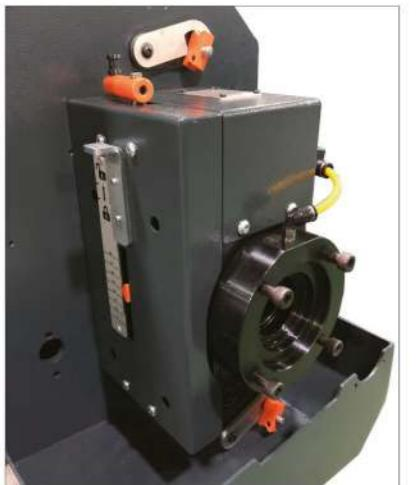
Модернизированный передний упор с универсальными V-образными направляющими элементами адаптируется к любому диаметру круглого прутка, погашают любую остаточную вибрацию и шум во всем диапазоне диаметров. Шестигранные и фасонные пруты значительно выигрывают от дополнительных О-образных направляющих элементов для достижения оптимальной производительности.
