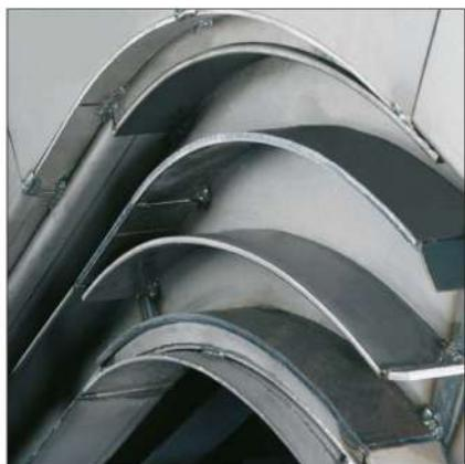
При вращении скребков на конце конвейера, мелкая стружка поднимается на верхнюю часть конвейерной ленты.
