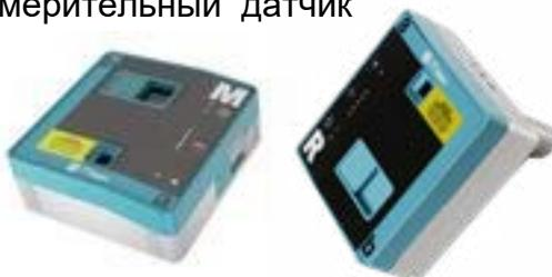
Meax SR201 и SM201 это многофункциональные датчики. В составе встроенные лазерные приемопередатчики, 2-осевой детектор PSD и инклинометр высокого разрешения для измерения отклонений. Датчики используются для различных типов измерений, таких как прямолинейность, параллельность, направление шпинделя и коаксиальность. Блок SR (обозначенный R) устанавливается на той части станка, которая потом считается эталоном, а датчик SM (обозначенный M) устанавливается на оси станка, для проведения измерений.
